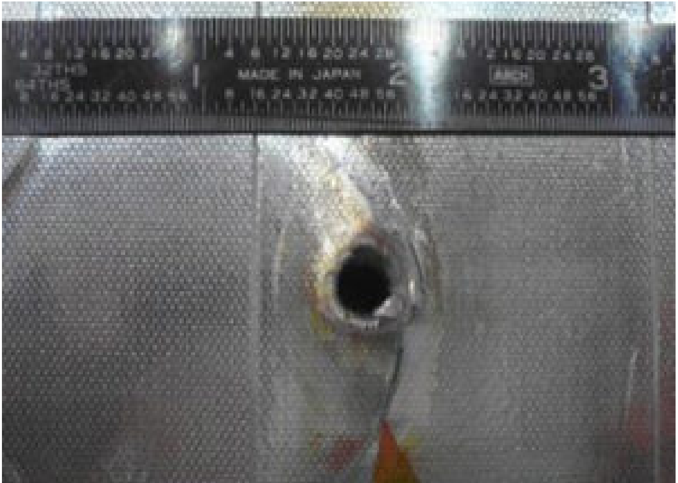
Impacto de un micrometeorito en el transbordador Endeavour (5,5 mm).
