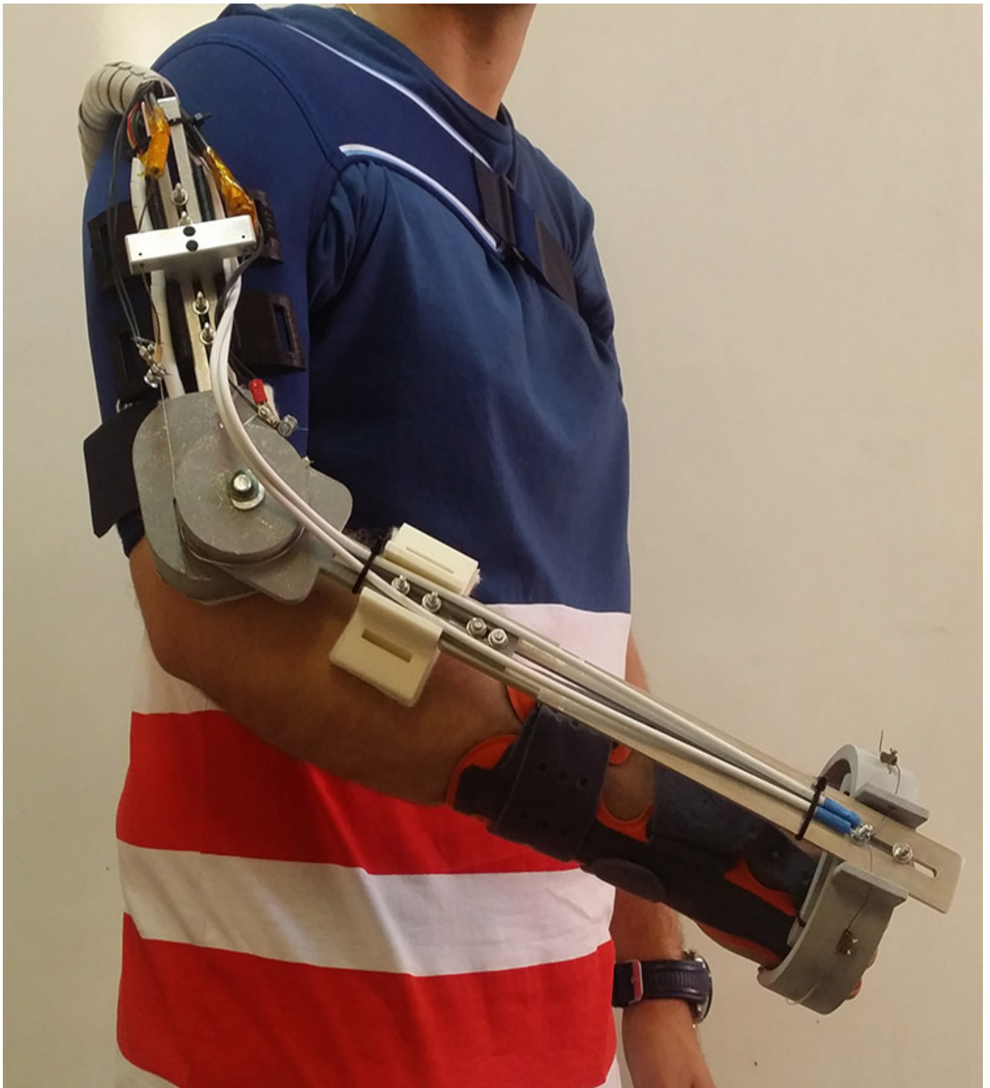
Figura 7. Exoesqueleto para la rehabilitación de brazo desarrollado por el RoboticsLab de la Universidad Carlos III de Madrid.
