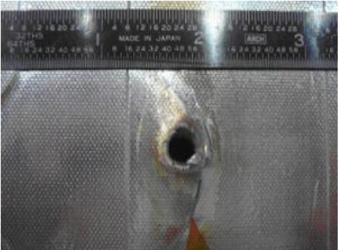
Impacto de un micrometeorito en el transbordador Endeavour (5,5 mm).
