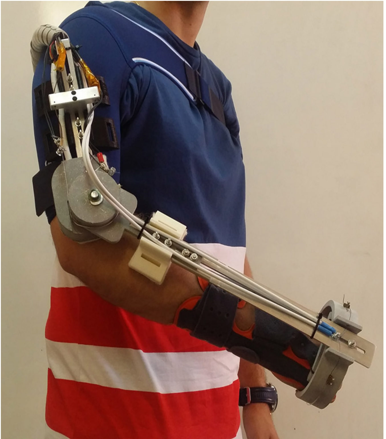
Figura 7. Exoesqueleto para la rehabilitación de brazo desarrollado por el RoboticsLab de la Universidad Carlos III de Madrid.
